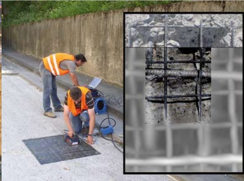
Radarmessung mit Ergebnissen, dargestellt als 3D-Tiefenbild
