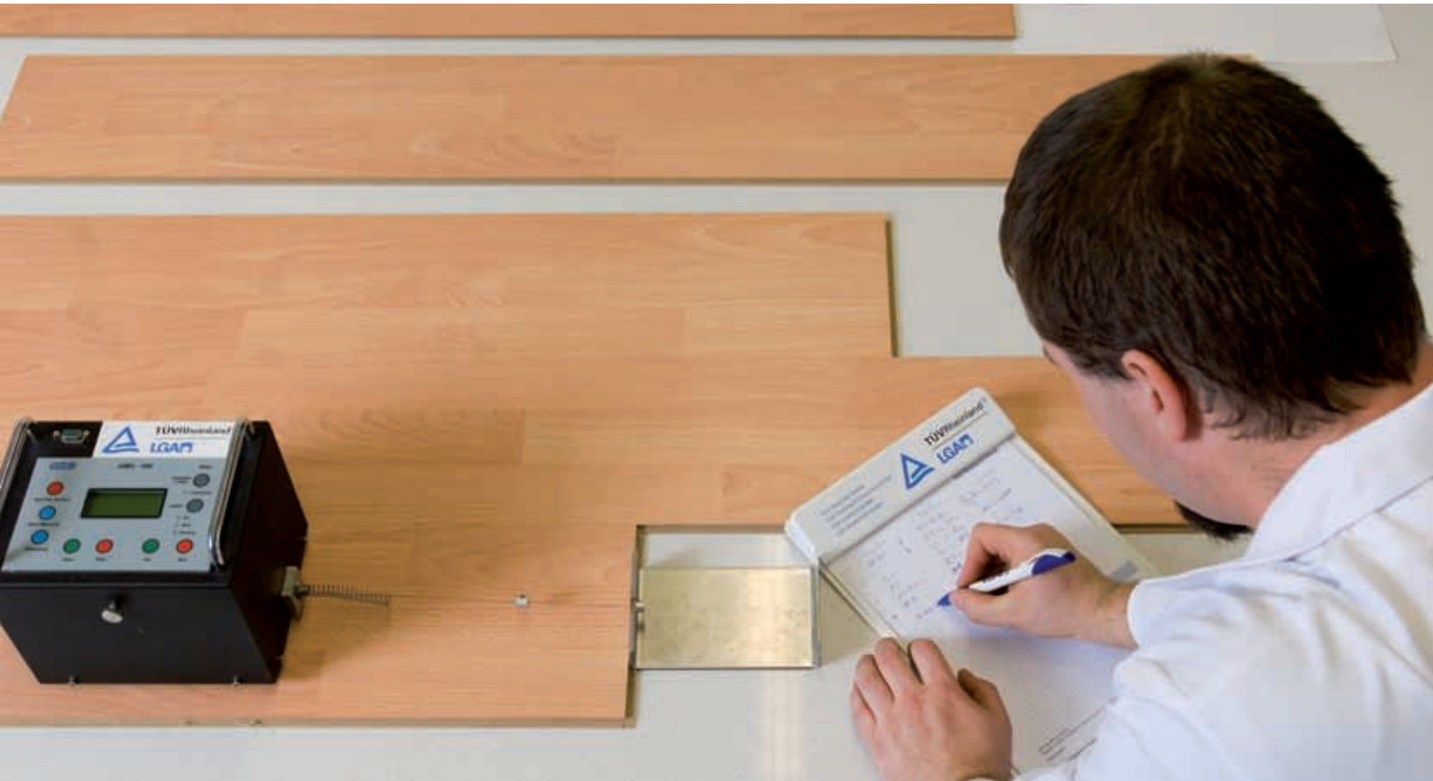
Prüfung der Gleitreibung bei Laminatböden
