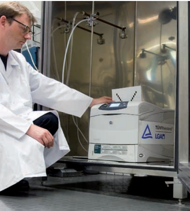
Emissionsprüfung in der Kammer an Laserdrucker
