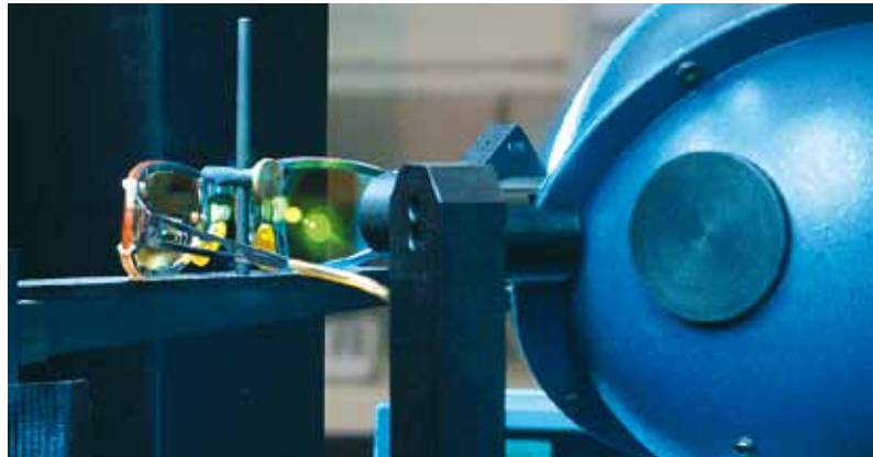
Die Ulbricht-Kugel dient zur exakten Messung von Lichtquellen.
