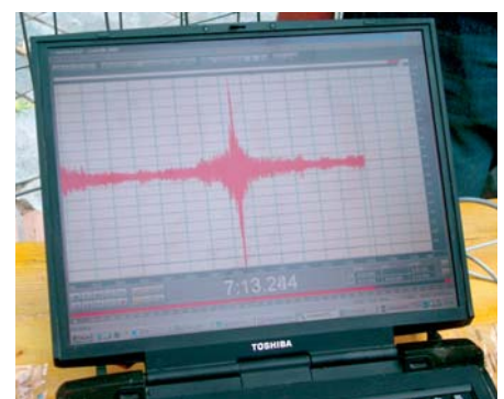
Abb. 13: Messsignal der Reichweitenbestimmung (Hydrophonmessung)
