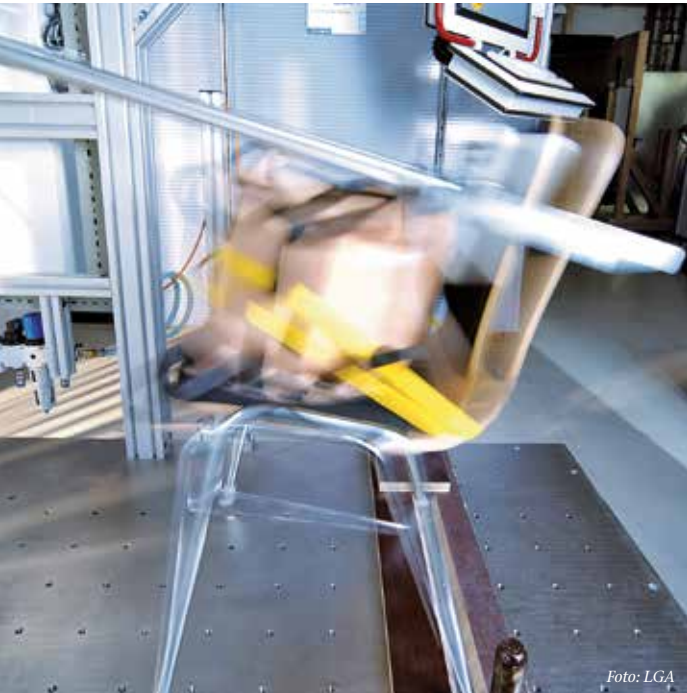
Standsicherheitsprüfung an einem Objektstuhl.
