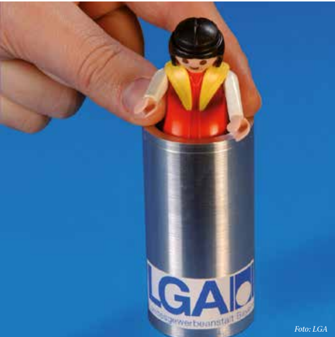
Prüfung auf verschluckbare Kleinteile im Prüfszylinder.
