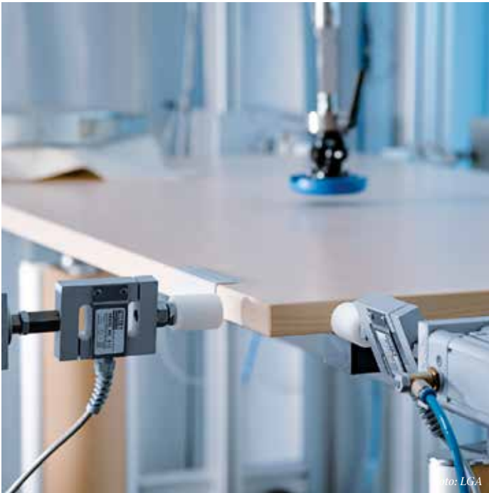
Standsicherheitsprüfung an einem Tisch.
